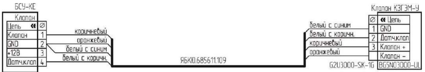
Рисунок А.5 – Типовая схема подключения клапана КЗГЭМ-У с разъемом BG5N03000-UL
