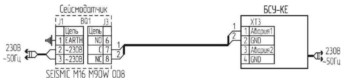
Рисунок 17 – Схема подключения сейсмического сенсора SEISMIC M16 M90W 008.
