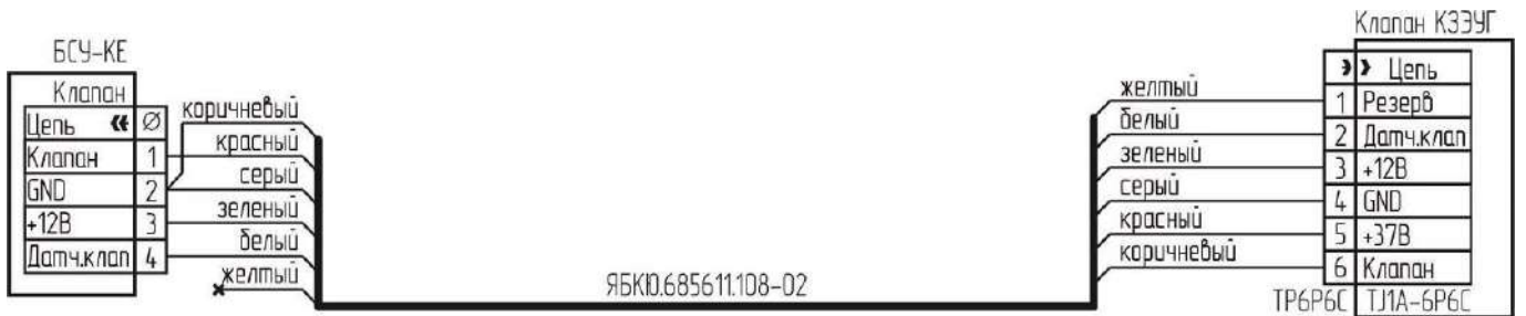
Рисунок А.6 – Типовая схема подключения клапана КЗЭУГ с разъемом TJ1A-6P6C
